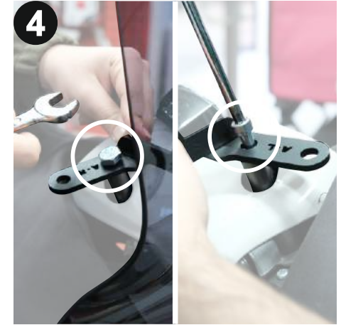
Sağ tarafı (anahtar başlı civata ve uzun burç) 17 anahtar ile, sol tarafı (imbus civata ve kısa burç) 6 alyan yardımı ile sabitleyiniz. (Secure the right side (bolt with hexagonal head and long bushing) using a 17 wrench, and the left side (hexagon socket bolt and short bushing) using a 6 Allen wrench.)
