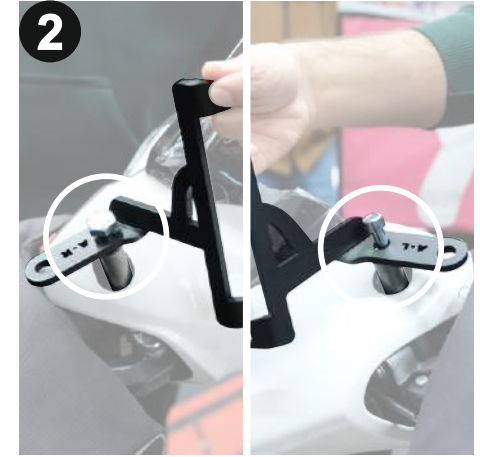
Sağ cam ayağını paket içerisinden çıkan anahtar başlı civata ve uzun burçla, sol ayağı ise imbus civata ve kısa burçla konumlandırınız. (Position the right glass foot using the bolt with hexagonal head and the long bushing from the package, and the left foot using the hexagon socket bolt and the short bushing.)
