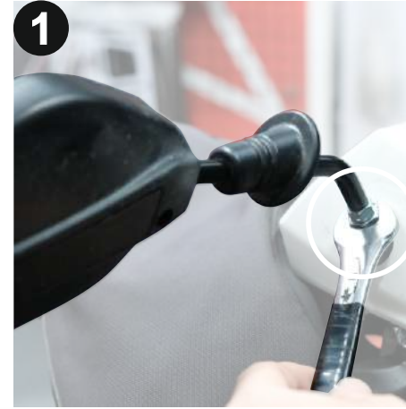
14 anahtar yardımı ile aynaları sökünüz. (Use a 14 wrench to remove the mirrors.)
