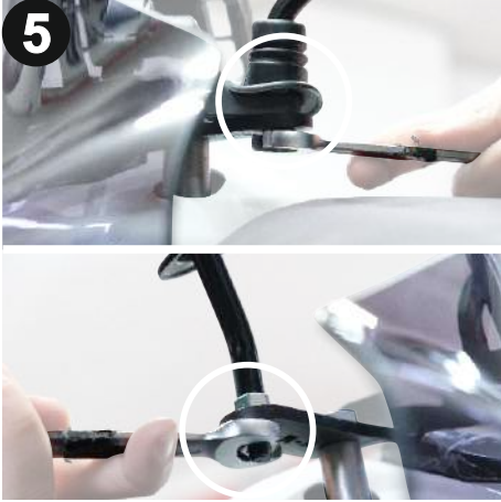
Aynaları ayaklara paket içerisinde çıkan somunlarla 12 anahtarıyla sabitleyiniz. (Secure the mirrors to the feet using the nuts from the package with the help of a 12 wrench.)
